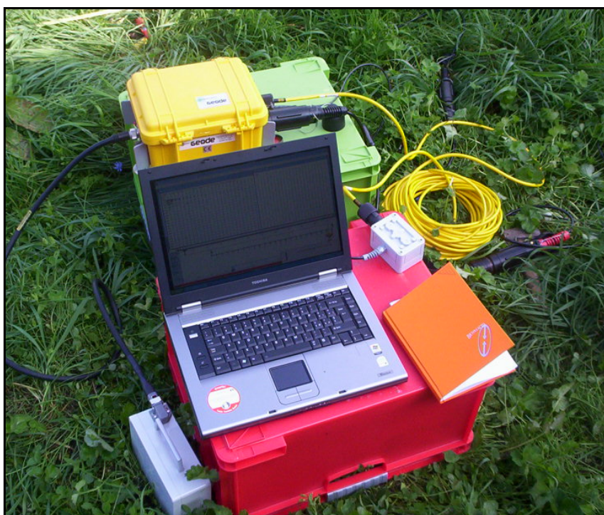
Figura 1: Strumentazione utilizzata per la prova MASW.
